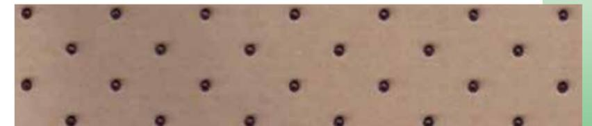
仕様 長さ20m(6坪巻) 幅1m 重量≒14.5kg 基材厚0.7mm 突起0.9mm 突起長手間隔9.5 幅間隔15.7(裏面合成紙)
