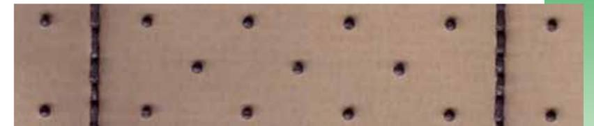
仕様 長さ20m(6坪巻) 幅1m 重量≒12.6kg 基材厚0.6mm 突起1.9mm 縦横2.5mm 縦横ピッチ102.1 突起長手間隔12.4 幅間隔22.8
